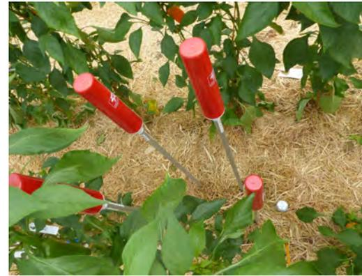
Bild 7: Mit diesen Sensoren und Tensiometern wird der Wasserbedarf der Pflanzen überwacht und gesteuert
