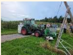
Abflamngerät „VarioFlame“ (Fa. Reinert) (Verbrauch: 32 kg Gas/ha)
