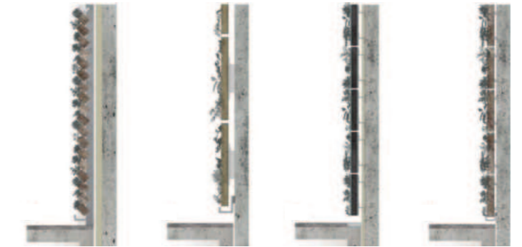
Prinzipschnitte modulare Bauweise
