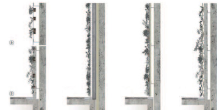
Prinzipschnitte flächige Bauweise
