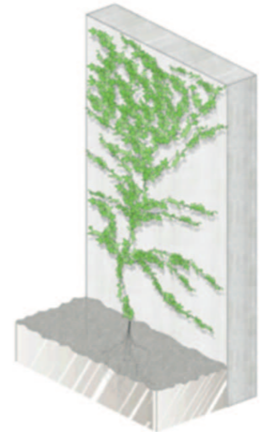
Prinzipschnitt bodengebundener + direkter Bewuchs
